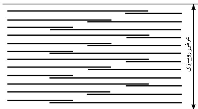
شکل ۲-۲۷- الگوی پله‌ای متناوب در همپوشانی میلگردهای طولی روسازی بتنی مسلح پیوسته
