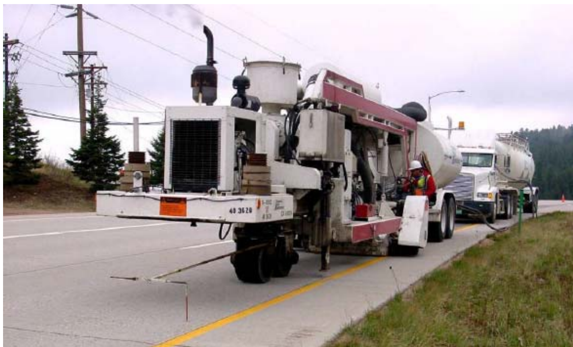
شکل ۴-۳۵- نمایی از ماشین ایجاد سایش
