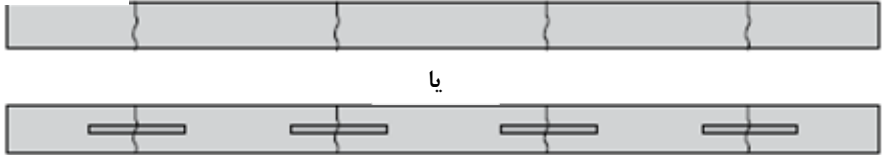
شکل ۱-۶- نمای کلی روسازی بتنی ساده درزدار (JPCP)
